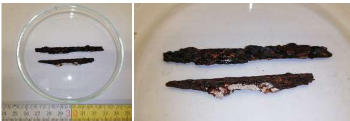
Obr. 9 a 10: Poskytnuté vzorky fragmentů předpínací výztuže k detailní korozní analýze
