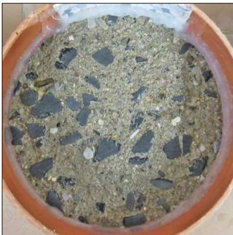
Foto 8: Líc vzorku V8-A po zkoušce – 75 cyklů celkový odpad 1743 g/m 2
