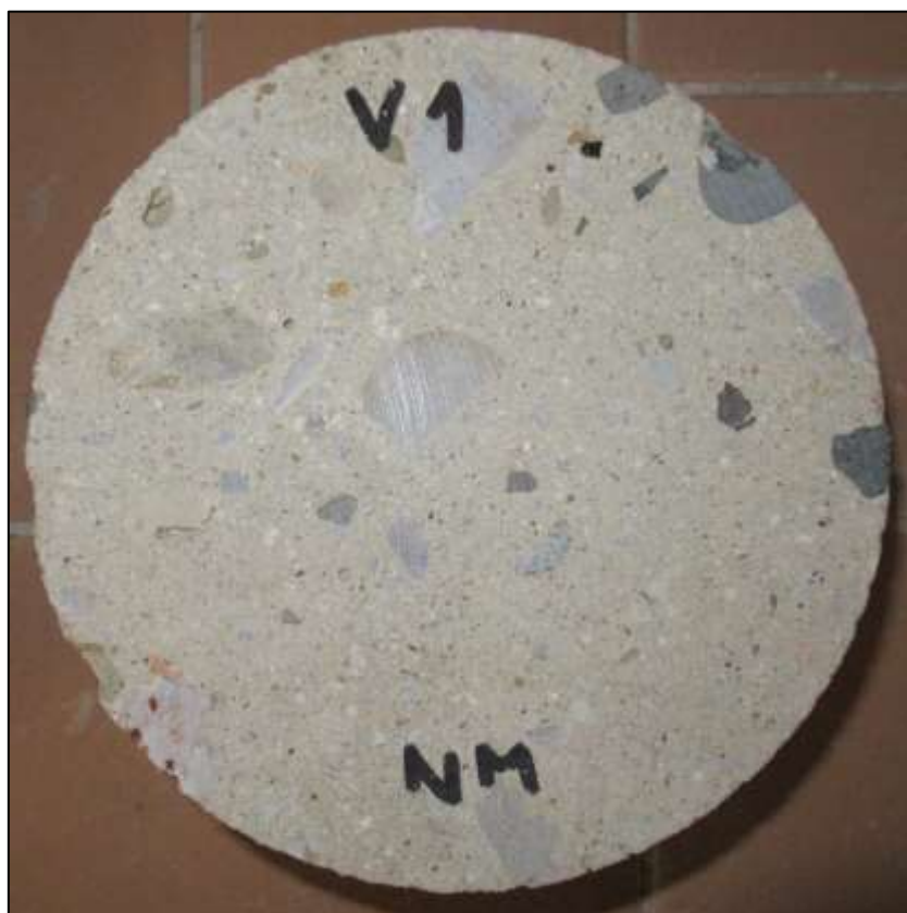
Foto 1: Líc vývrtu V1 před zkouškou
