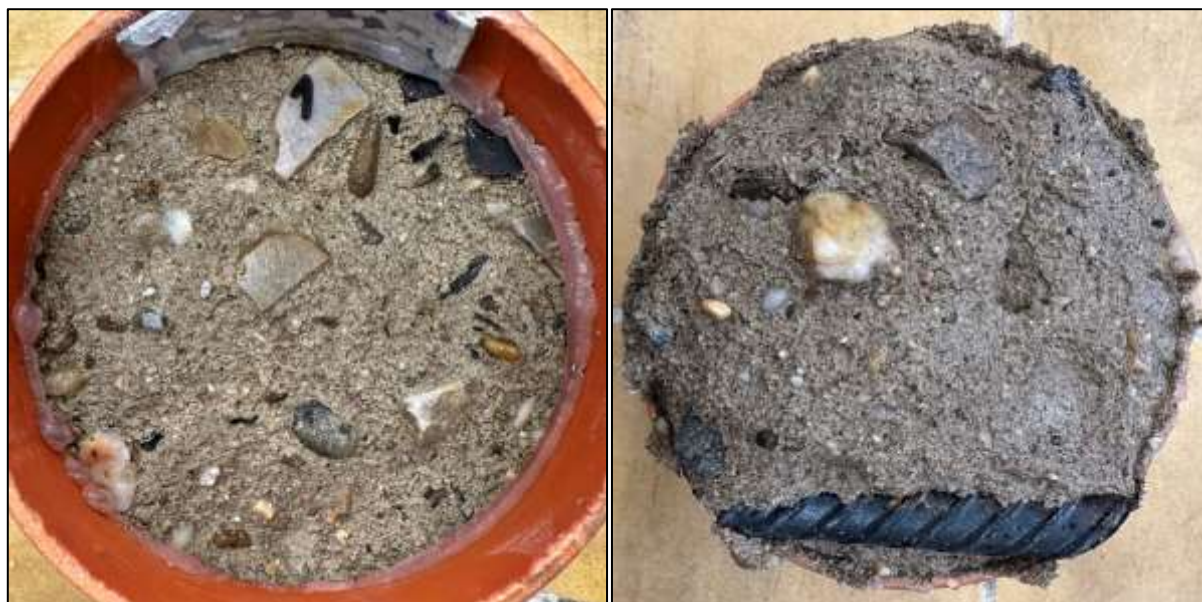
Foto 2: Líc (vlevo) a rub (vpravo) vzorku V1 po zkoušce – 50 cyklů celkový odpad 6392 g/m 2 Zaznamenán rozpad čelní i rubové plochy zkušebního vzorku
