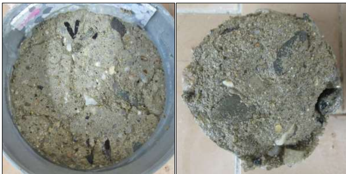
Foto 4: Líc (vlevo) a rub (vpravo) vzorku V4 po zkoušce – 75 cyklů celkový odpad 579 g/m 2
