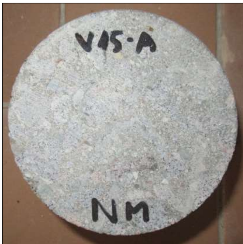
Foto 13: Líc vývrtnu V15-A před zkouškou
