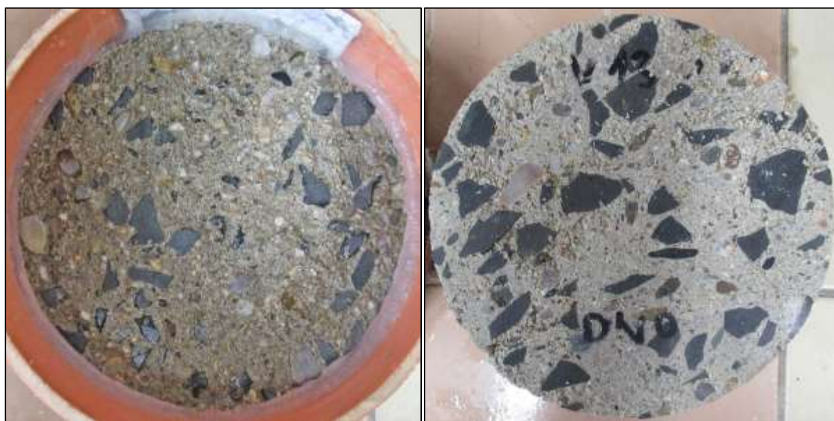
Foto 12: Líc (vlevo) a rub (vpravo) vzorku V13-A po zkoušce – 75 cyklů celkový odpad 1832 g/m 2 Zaznamenán počátek rozpadu rubové plochy zkušebního vzorku
