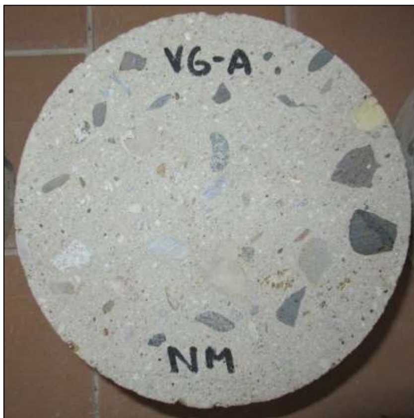
Foto 5: Líc vývrtnu V6-A před zkouškou
