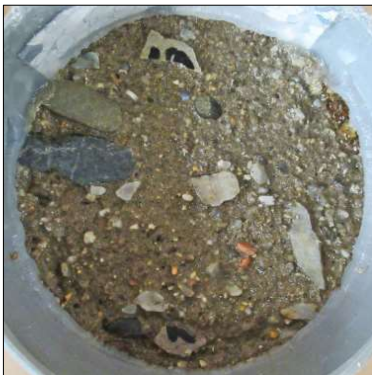
Foto 20: Líc vzorku V19-A po zkoušce – 75 cyklů celkový odpad 2598 g/m 2
