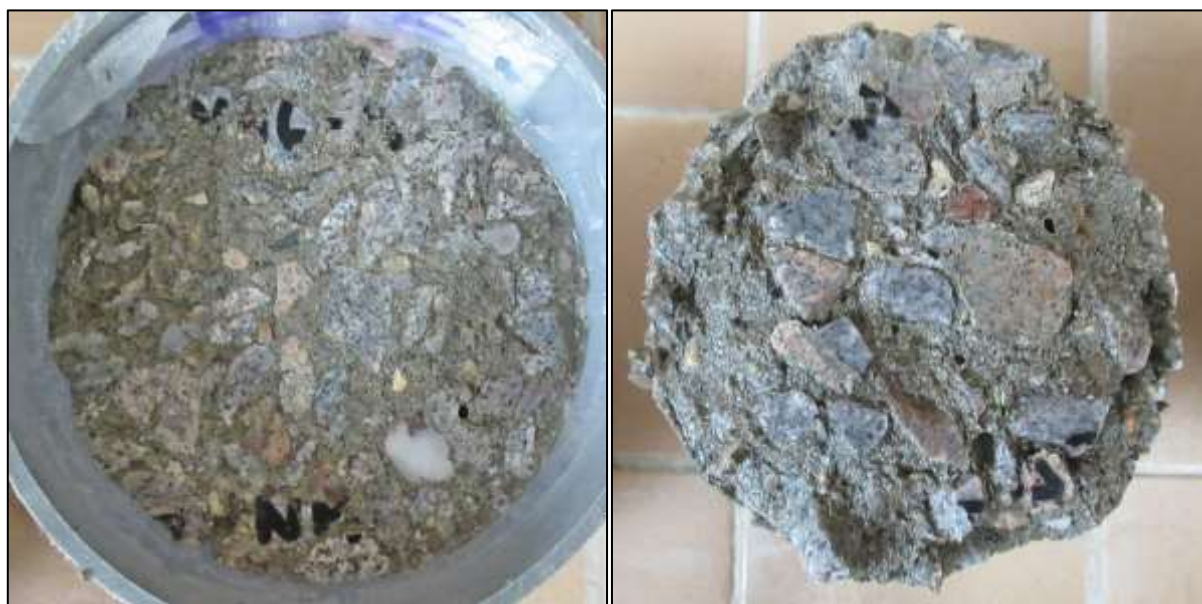
Foto 16: Líc (vlevo) a rub (vpravo) vzorku V16-A po zkoušce – 75 cyklů celkový odpad 316 g/m 2
