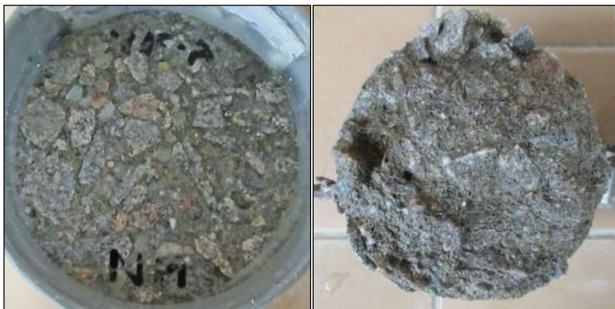
Foto 14: Líc (vlevo) a rub (vpravo) vzorku V15-A po zkoušce – 75 cyklů celkový odpad 182 g/m 2
