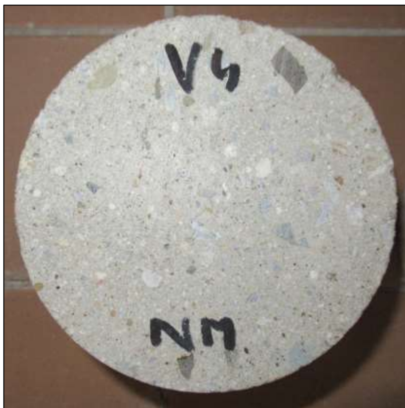
Foto 3: Líc vývrtu V4 před zkouškou
