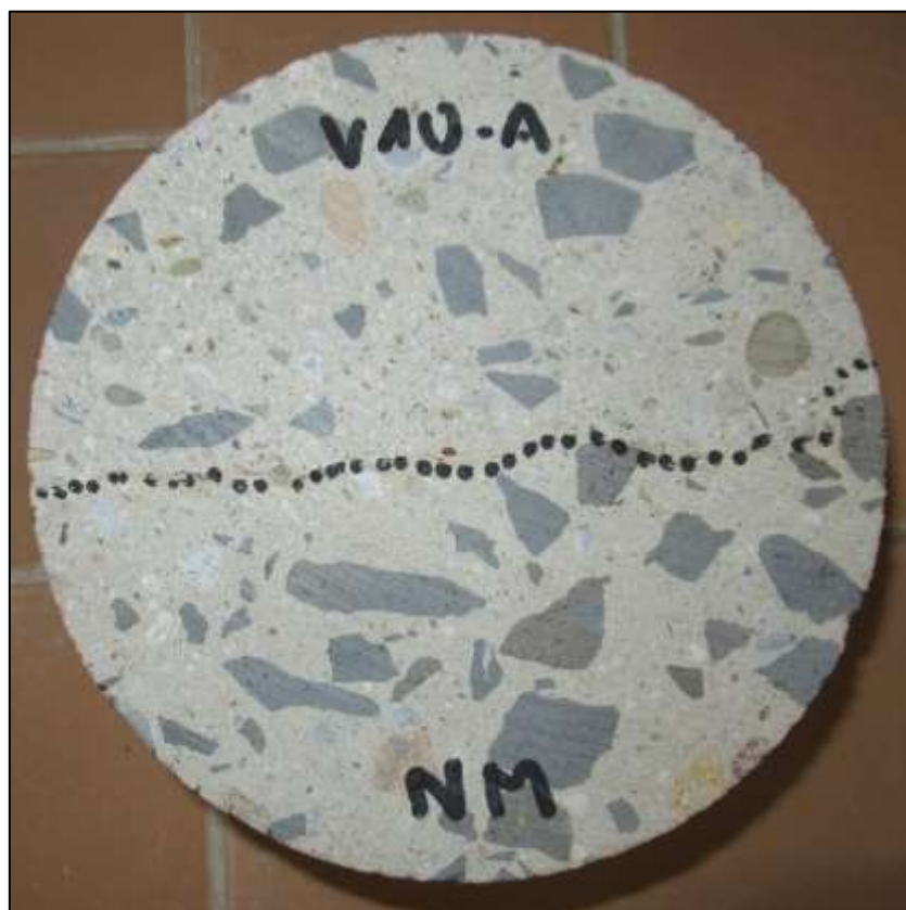
Foto 9: Líc vývrtu V10-A před zkouškou
