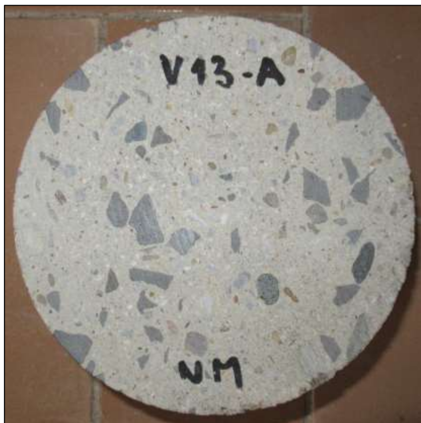
Foto 11: Líc vývrtnu V13-A před zkouškou
