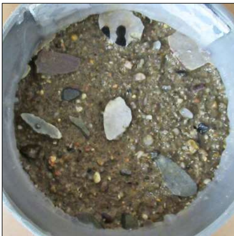
Foto 18: Líc vzorku V18 po zkoušce – 75 cyklů celkový odpad 3442 g/m 2
