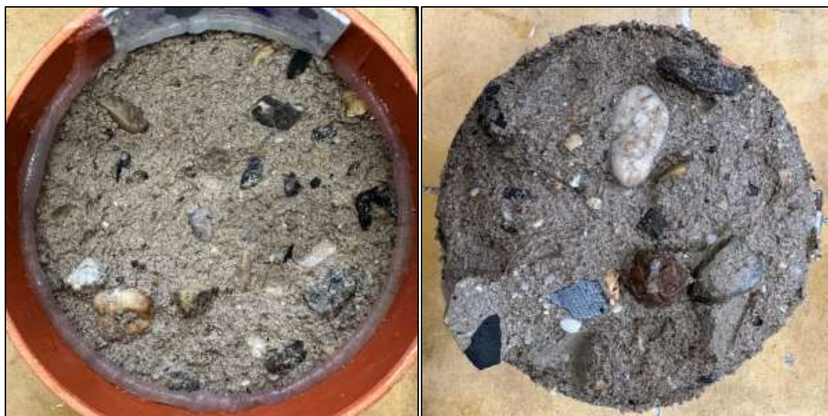
Foto 6: Líc (vlevo) a rub (vpravo) vzorku V6-A po zkoušce – 50 cyklů celkový odpad 8447 g/m 2
